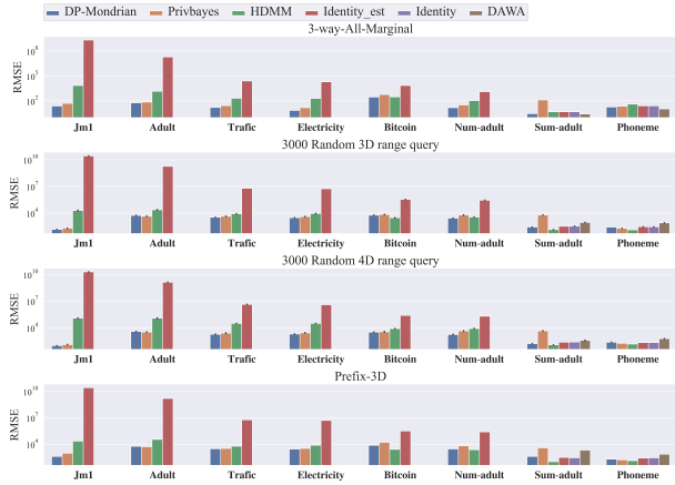
図 3: DP-MONDRIAN は多次元データ上の多様なレンジカウンクエリに対して小さな誤差を示す。
