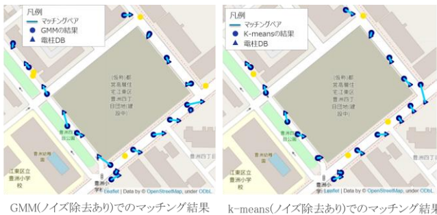
図 10 SLAM での物体位置認識 20 回分の結果を, GMM と k-means で複数回クラスタリングしてノイズ除去したものを用いたマッチングの結果. クラスタリング一回の結果と比較して, 大きく精度改善していることが分かる.
