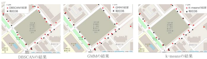
図 6 SLAM による物体位置認識 20 回分を、各手法で一度だけクラスタリングした結果を地図上にプロットしたもの.
