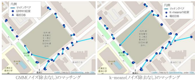
図 9 SLAM での物体位置認識 20 回分の結果を, GMM と k-means で一度だけクラスタリングしたものを用いたマッチングの結果. SLAM 一回と比較すると高精度になっているが, 地図右端のノイズデータに大きく影響されていることがわかる.
