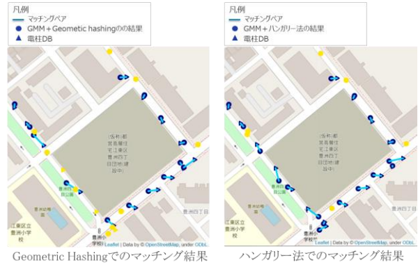
図 11 Geometric Hashing とハンガリー法でのマッチング結果の違い. ハンガリー法のほうが高精度であることが分かる.
