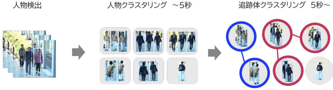
図 2: 提案手法の全体アーキテクチャ。出現時間差が 5 秒以内の人物矩形間は人物クラスタリングによってデータ関連付けを行う。出現時間差が 5 秒以上の人物矩形間のデータ関連付けは、人物クラスタリングで算出した追跡体をデータ単位とした追跡体クラスタリングによって実施する。
